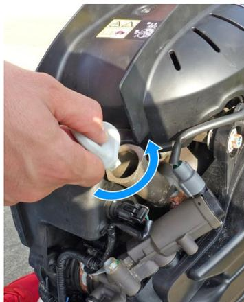
9. Retirez le bouchon du réservoir d'huile.
