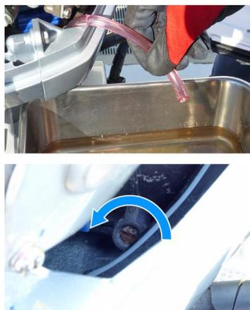
5. Desserrez la vis de purge du séparateur de vapeur. Collectez l'essence dans le bac de récupération tandis qu'il s'écoule du tuyau de vidange.
