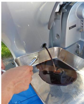
10. Placez un récipient adapté sous le guide de vidange d'huile, retirez la vis de purge d'huile moteur et la rondelle. Vidangez l'huile moteur jusqu'à ce que le débit de l'huile usagée soit réduit à un filet.
