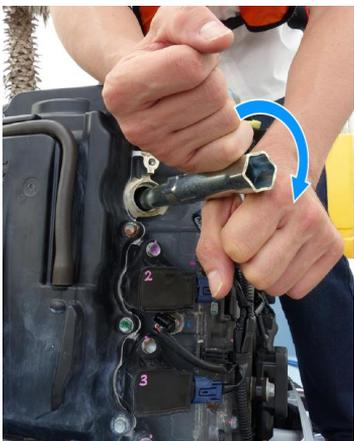
17. Montez les bougies à la main avec soin pour ne pas déformer le filetage. Serrez de 1/8—1/4 de tour une fois que la bougie est en place. Montez le capot de l'alternateur.
