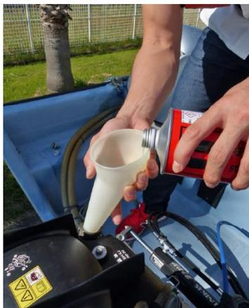
12. Remplissez jusqu'au repère de niveau supérieur sur la jauge de niveau d'huile avec l'huile recommandée. Ne remplissez pas trop. Une trop grande quantité d'huile peut nuire au moteur.
