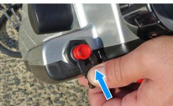
11. Insérez l'attache d'urgence dans le commutateur d'arrêt d'urgence. Fixez bien l'autre extrémité de la sangle du commutateur d'arrêt d'urgence à l'utilisateur.
