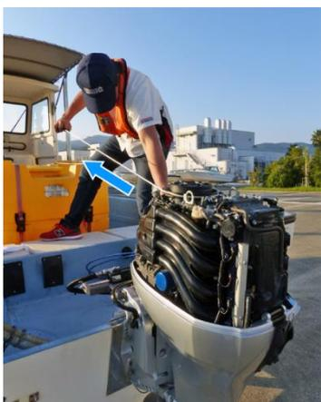
16. Tirez plusieurs fois sur le cordon du démarreur d'urgence pour lubrifier l'intérieur du cylindre. Retirez ensuite le cordon du démarreur d'urgence. Reportez-vous à « Si le système de démarrage ne fonctionne pas » pour régler le problème lié au cordon du démarreur d'urgence.
