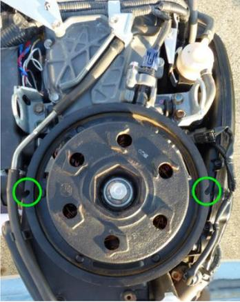
8. Tournez le rotor de l'alternateur dans le sens des aiguilles d'une montre de telle sorte que les découpes se trouvent sur les côtés droit et gauche du rotor de l'alternateur comme illustré.
