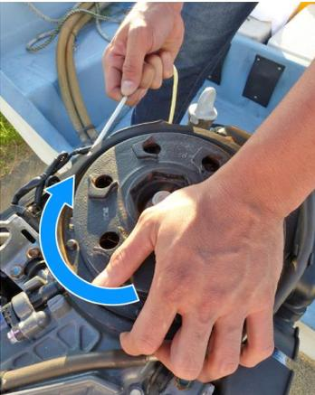
10. Enroulez le cordon du démarreur d'urgence dans le sens des aiguilles d'une montre autour du volant le long de la rainure du rotor de l'alternateur.
