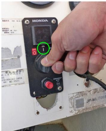
12. Mettez l'interrupteur du moteur en position ON (marche).
