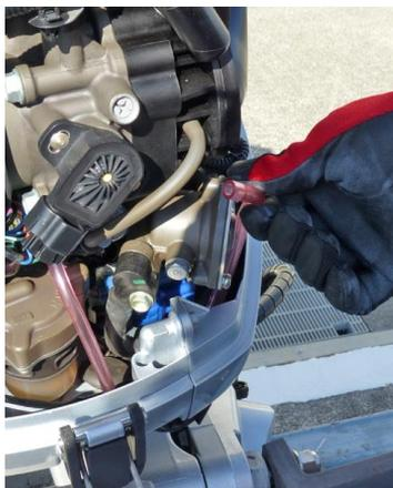
3. Détachez le tuyau de vidange de la saillie du collecteur d'admission et faites sortir l'extrémité du tuyau de vidange du dessous du capot.
