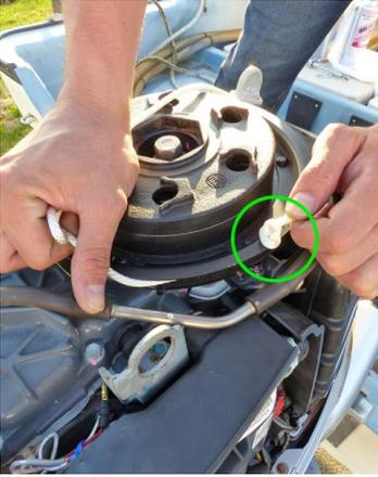
9. Sur la corde du lanceur de secours, prenez l'extrémité comportant un nœud et insérez-la dans l'encoche de la poulie du lanceur.
